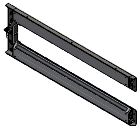
Специальный корпус для «вилочной» конструкции световой шторы
