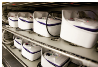
Перед отгрузкой каждая камера проходит испытания при экстремальных температурах.
