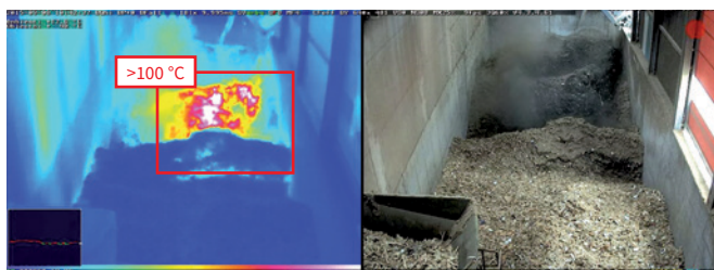
Тепловая радиометрия (TR): автоматическое оповещение при выходе температуры за рамки заданного диапазона
