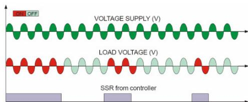
Режим **ZC** (**Z**ero **C**rossing = нулевое переключение) используется для регулирования мощности на нагрузке посредством внешнего релейного сигнала или сигнала с релейного выхода регулятора температуры. Тиристор при этом работает как выключатель, а время цикла (ON/OFF) задается от внешнего сигнала. Режим ZC уменьшает электромагнитные помехи, так как тиристор переключается при переходе напряжения через ноль.
